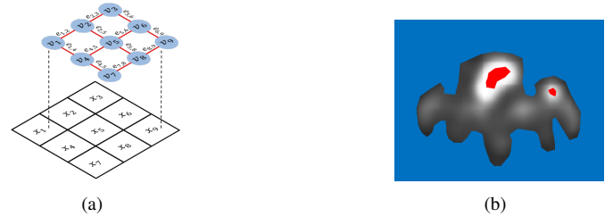
FIGURE 4 – (a) Une image I comme un graphe G(V, E) . (b) g_f en rouge et g_b en bleu.
