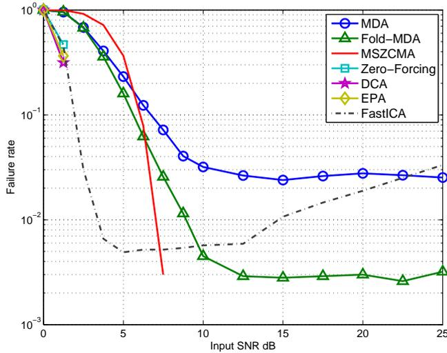
FIGURE 2 – Taux d'échec en fonction du SNR d'entrée.
