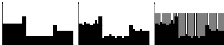
FIG. 4.14 – Exemple de sur-segmentation lors d’un traitement par ligne de partage des eaux. À gauche : image idéale. Au milieu : image bruitée correspondante. À droite : segmentation de l’image bruitée par ligne de partage des eaux (images en noir, ligne de partage des eaux en blanc, zones segmentées en gris). L’image segmentée contient de multiples zones induites par les minima locaux générés par le bruit. Idéalement, seules trois zones, correspondant aux minima réels de l’image initiale auraient dû être détectées.
