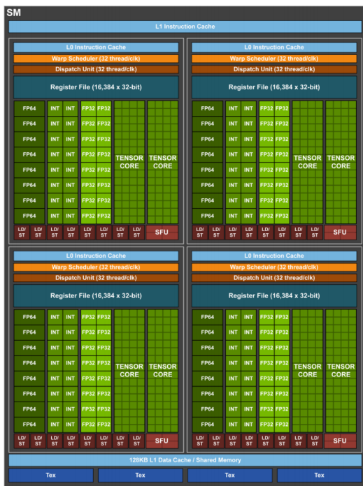
FIGURE 1.5 – Architecture des cartes Nvidia Volta V100. Organisation des différents coeurs de calcul et niveaux de mémoire au sein d'un multi-processeur. (source: Nvidia – http://images.nvidia.com/content/volta-architecture/pdf/volta-architecture-whitepaper.pdf ).
