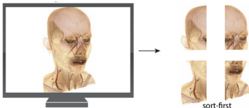
FIGURE 2.13 – Méthode de rendu distribué "Sort-first" . La répartition des calculs sur les différentes unités de rendu se fait selon une distribution du domaine dans l'espace image. (source : [BHP15]).
