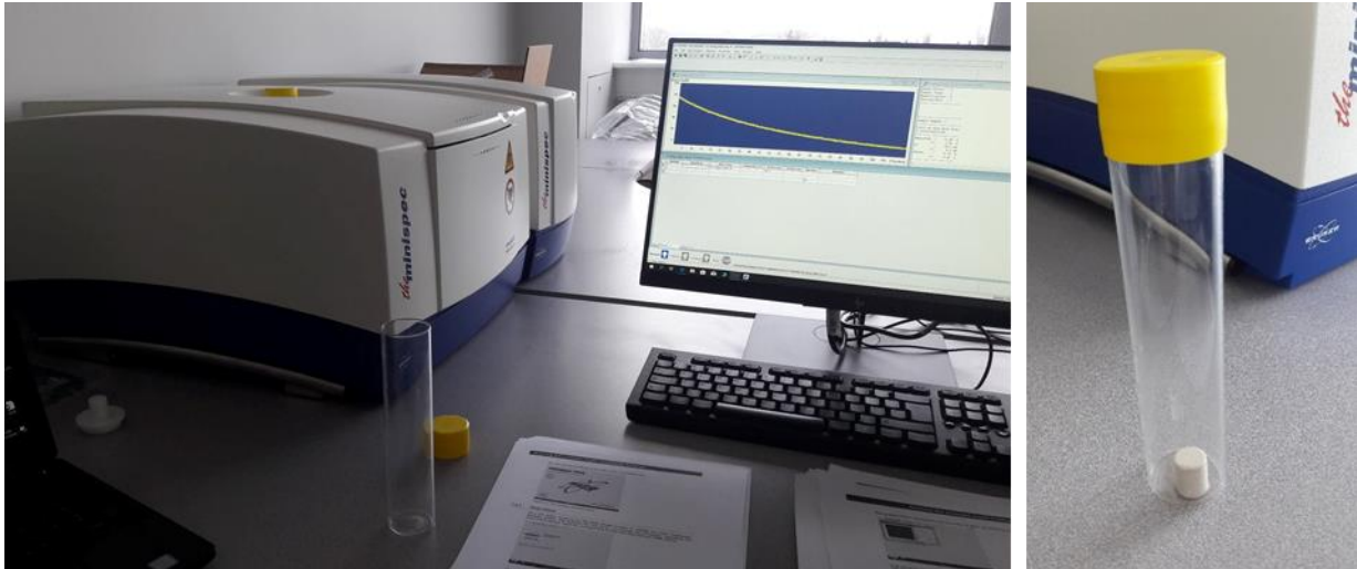
Figure II-27. Appareil RMN Minispec et ordinateur de contrôle. Échantillon saturé dans un récipient en verre.
