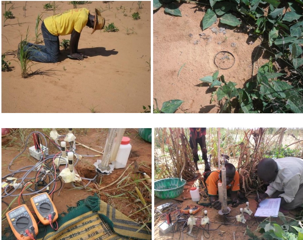
Figure 66: Vue du dispositif de mesures sur le terrain. 1. mise en place du cylindre. Le cylindre est enfoncé à la main en exerçant une pression au moyen d'une plaque métallique légère 2. Vue du cylindre mis en place. 3. Vue d'ensemble du tensio-infiltromètre. 4. Opération de mesures de conductivité hydraulique à saturation en cours
