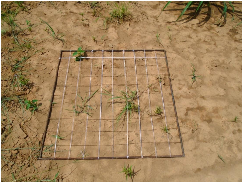
Figure 61: Dispositif permettant le relevé des états de surface. Le cadre métallique mesure 1m x 1m. La mesure est effectuée dans une EHS de type DEC. Noter les structures desquamées caractéristiques des croûtes de décantation.
