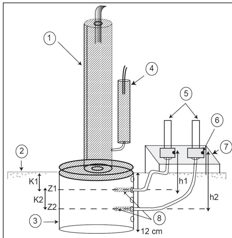
**Figure 64: Dispositif de mesure de la conductivité hydraulique *in situ* (tensio-infiltrométrie)**
