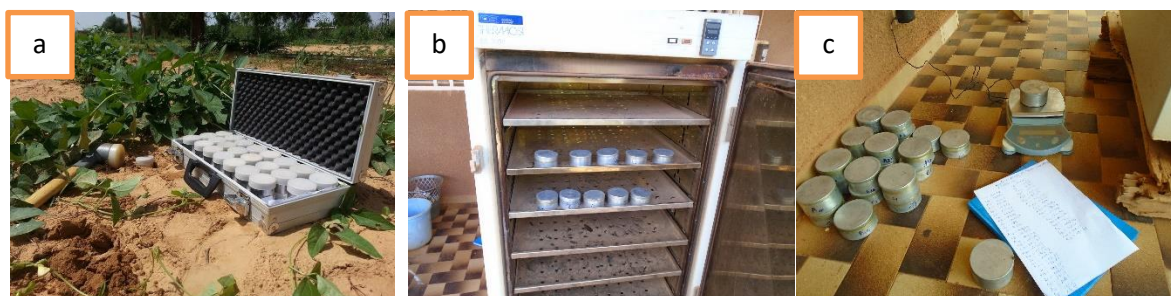
Figure 46: Illustration de la procédure de mesure de la densité apparente. a) vue de la surface du sol et des cylindres de prélèvement. b) séchage des échantillons à 105 °C. c) mesure de la masse des échantillons.
