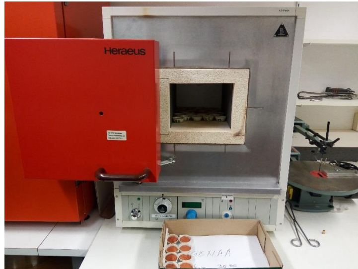
Figure 45: Vue du four de calcination. A noter les échantillons placés dans les creusets et posés à l'intérieur et à l'extérieur du four de calcination.
