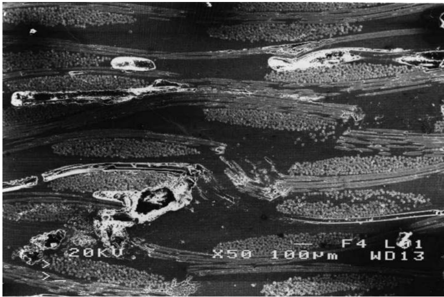
Photo III.12 Zone endommagée (matériau SERH/M18/PE/SI/NV / essai de flexion)
