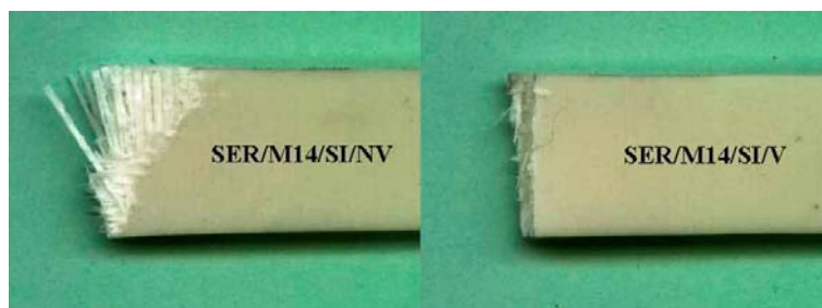
Photo III.6 Faciès de rupture en traction du matériau sergé SER/M14/SI (Non vieilli à gauche et Vieilli à droite)
