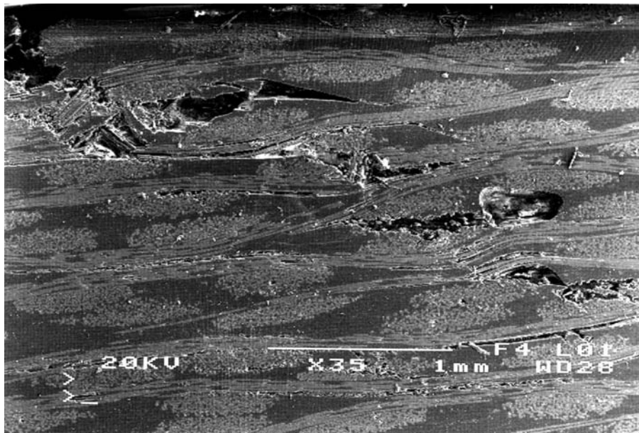
Photo III.20 Rupture d'interface du type 2 (matériau SER/M14/SI/NV / essai de cisaillement)
