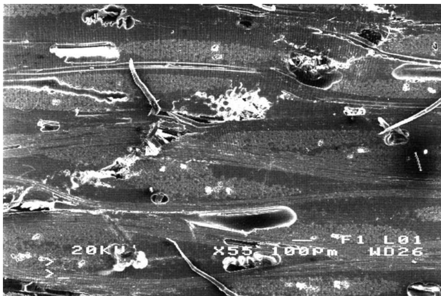
Photo III.24 Rupture d'interface du type 1 dans les mèches Pe et du type 2 dans les mèches Si (matériau SERH/M14/PE/SI/NV / essai de cisaillement).
