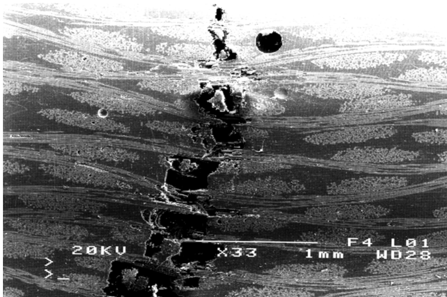
Photo III.21 Rupture nette des mèches longitudinales (matériau SER/M14/SI/V / essai de cisaillement).
