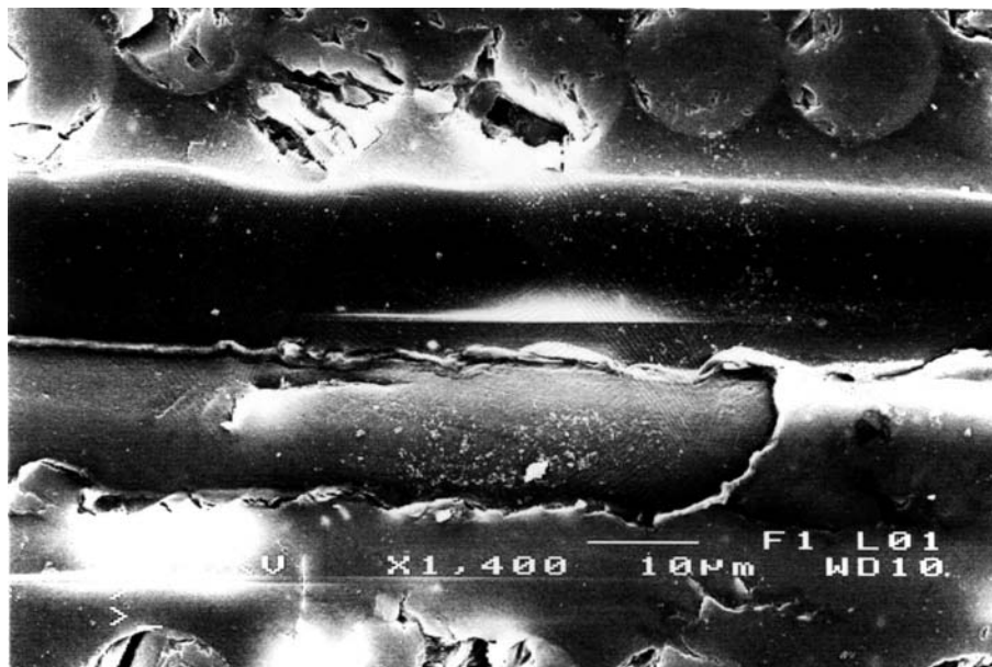
Photo III.18 Rupture d'interface Pe/résine (matériau SERH/M14/PE/SI/V / essai de flexion).
