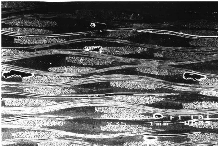
Photo III.4 Fissures longitudinales au niveau des fibres Pe (matériau SERH/M14/PE/SI/NV / essai de traction).
