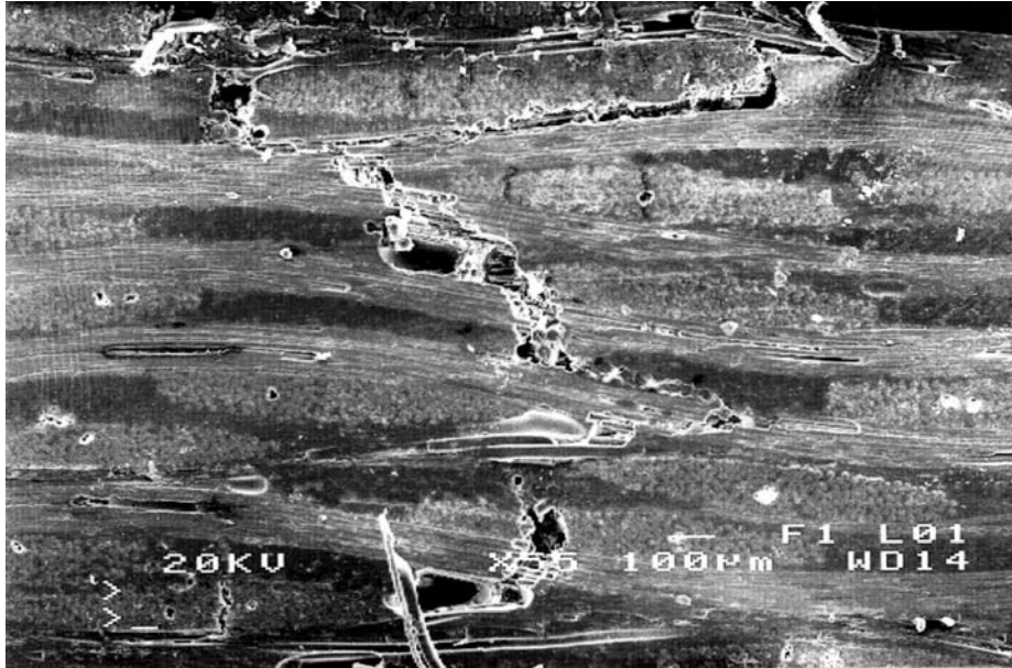
Photo III.25 Rupture nette des mèches longitudinales (matériau SERH/M14/PE/SI/V / essai de cisaillement).
