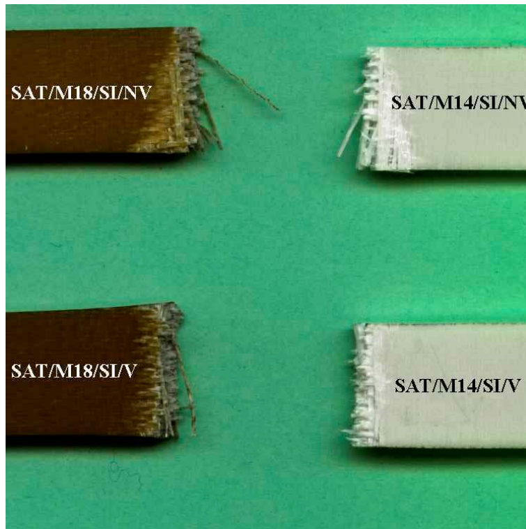
Photo III.7 Facès de rupture en traction des matériaux satin (SAT/M18/SI à gauche et SAT/M14/SI à droite)
