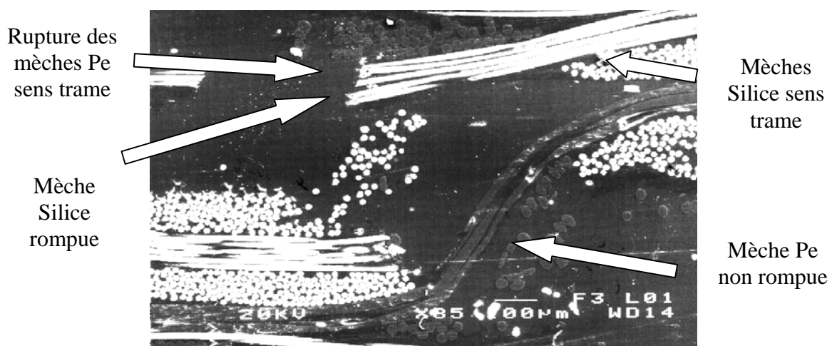
Figure IV.32 Faciès de rupture lors d'un essai de compression sur le composite SERH/M18/PE/SI
